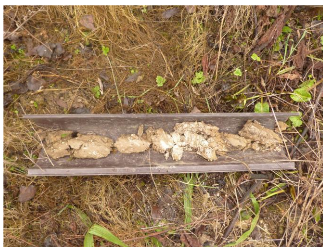
Figure 14 : profil de sol du sondage 9.
